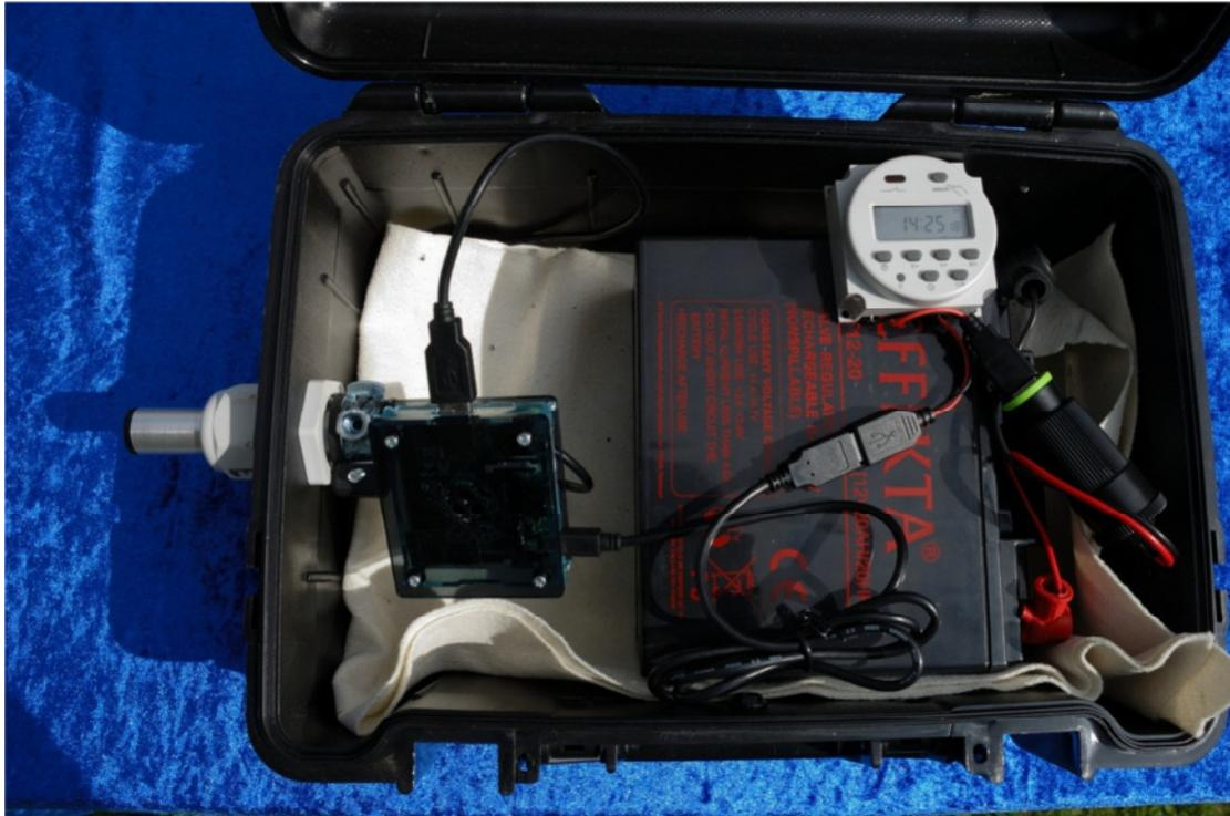
RaspberryPi **Modell A+** mit 20 Ah Bleigelakku, Cottenpickers clock timer, Belkin Spannungswandler 12/5 Volt und Dodotronic Ultramic250K im wasserdichten XCASE
