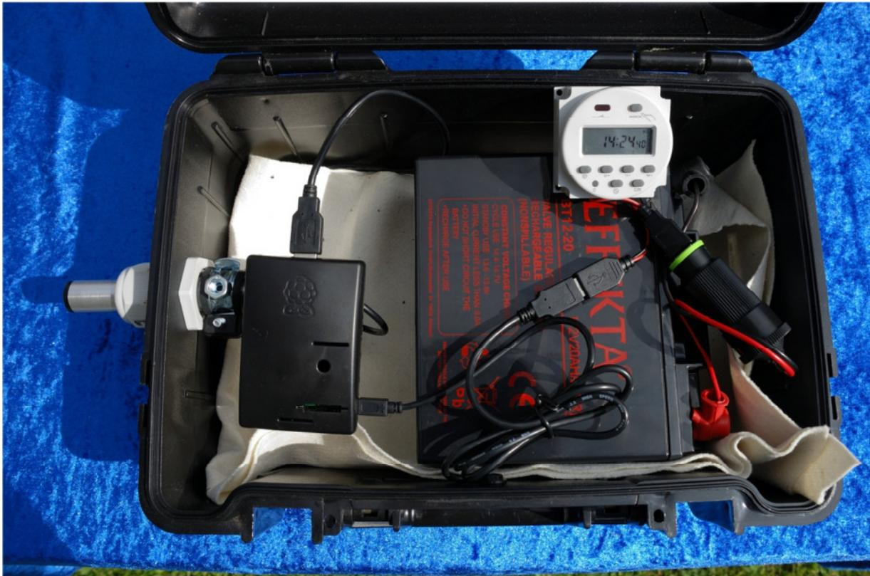
RaspberryPi **Model B+** mit 20 Ah Bleigelakku, Cottonpicker clock timer, Belkin Spannungswandler 12/5 Volt und Dodotronic Ultramic250K im wasserdichten XCASE
