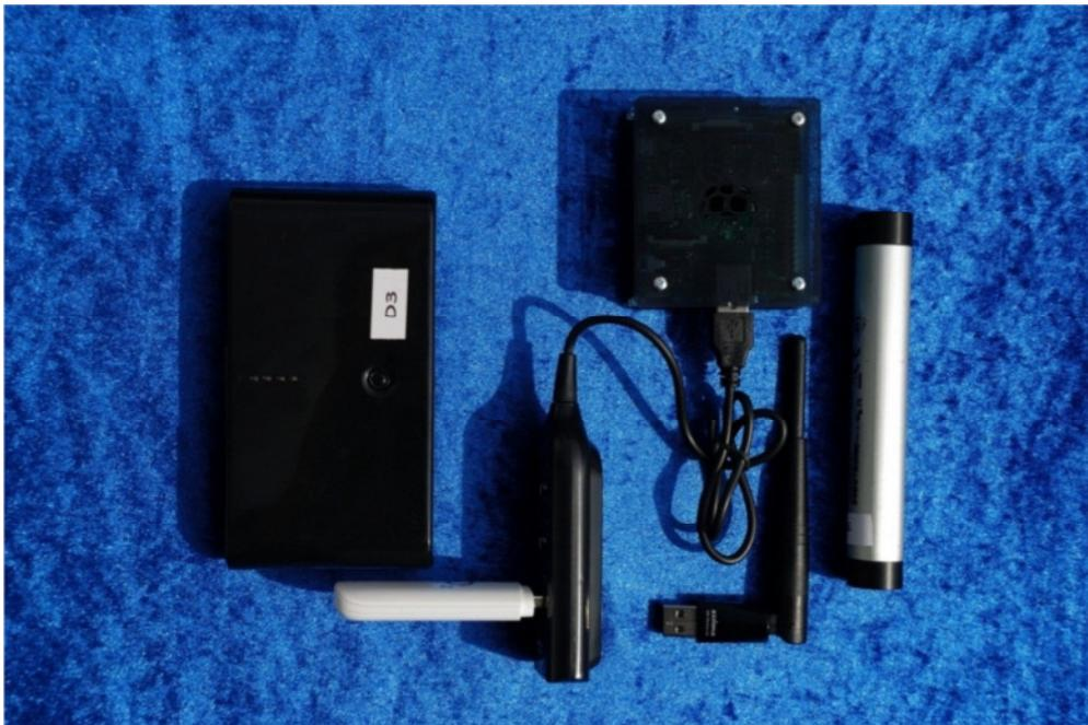
mit Dadidong Akku, Wlan-Antenne Edimax, USB Hub (zusätzlich notwendig, falls mehr als das Mikrofon angeschlossen werden sollte), UMTS Stick Huawei Model E173u-1 und Dodotronic Ultramic250K
